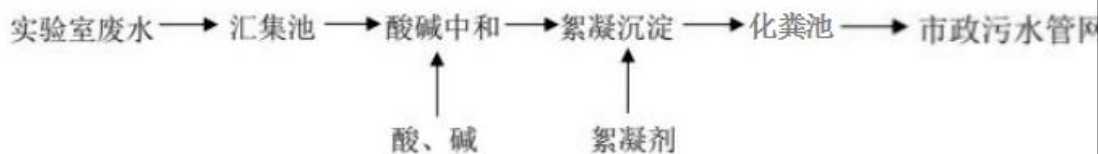
图 4-2 项目废水处理工艺流程
